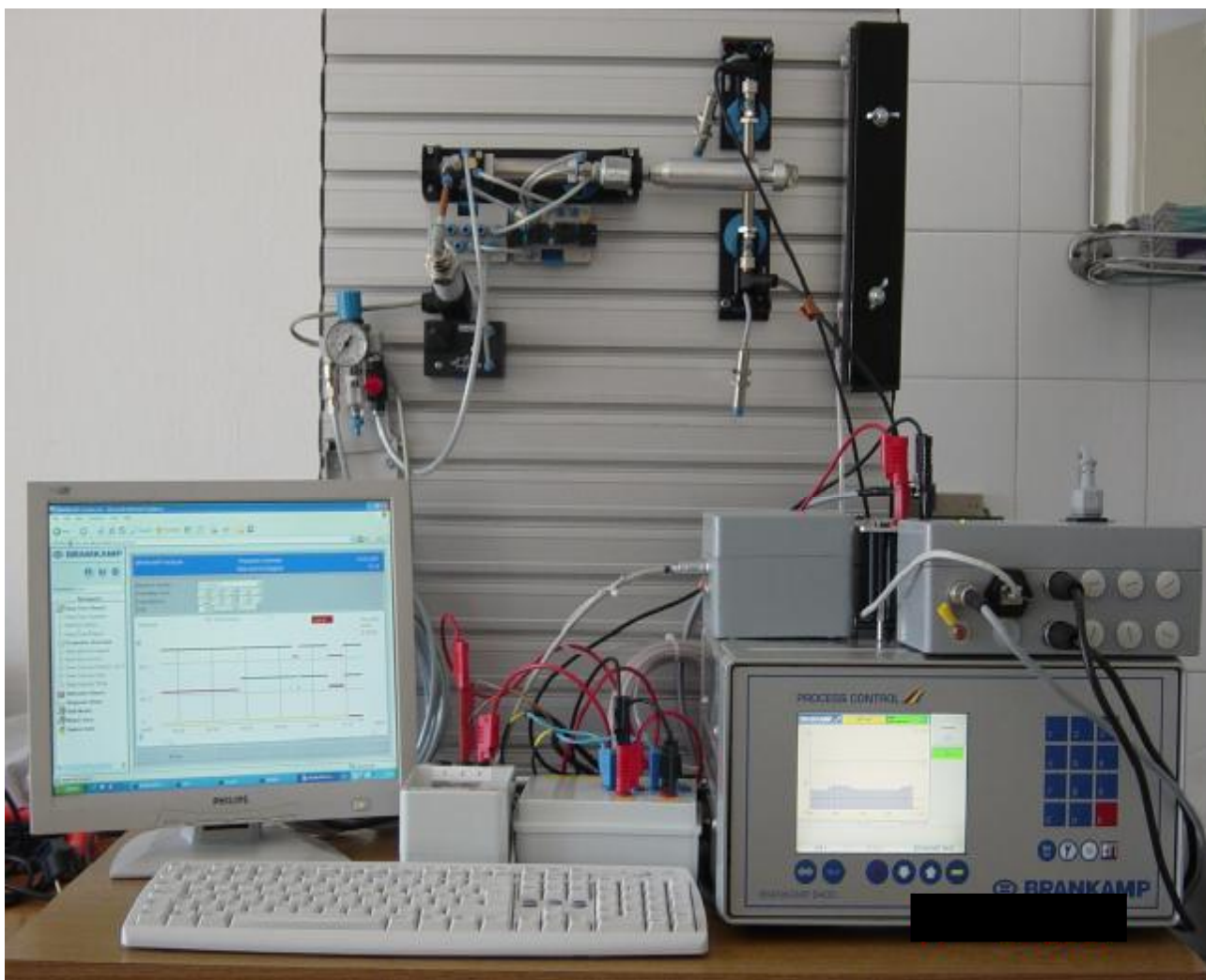
Slika 3: Didaktični mehatronski sistem za dinamično merjenje sile na stroju
